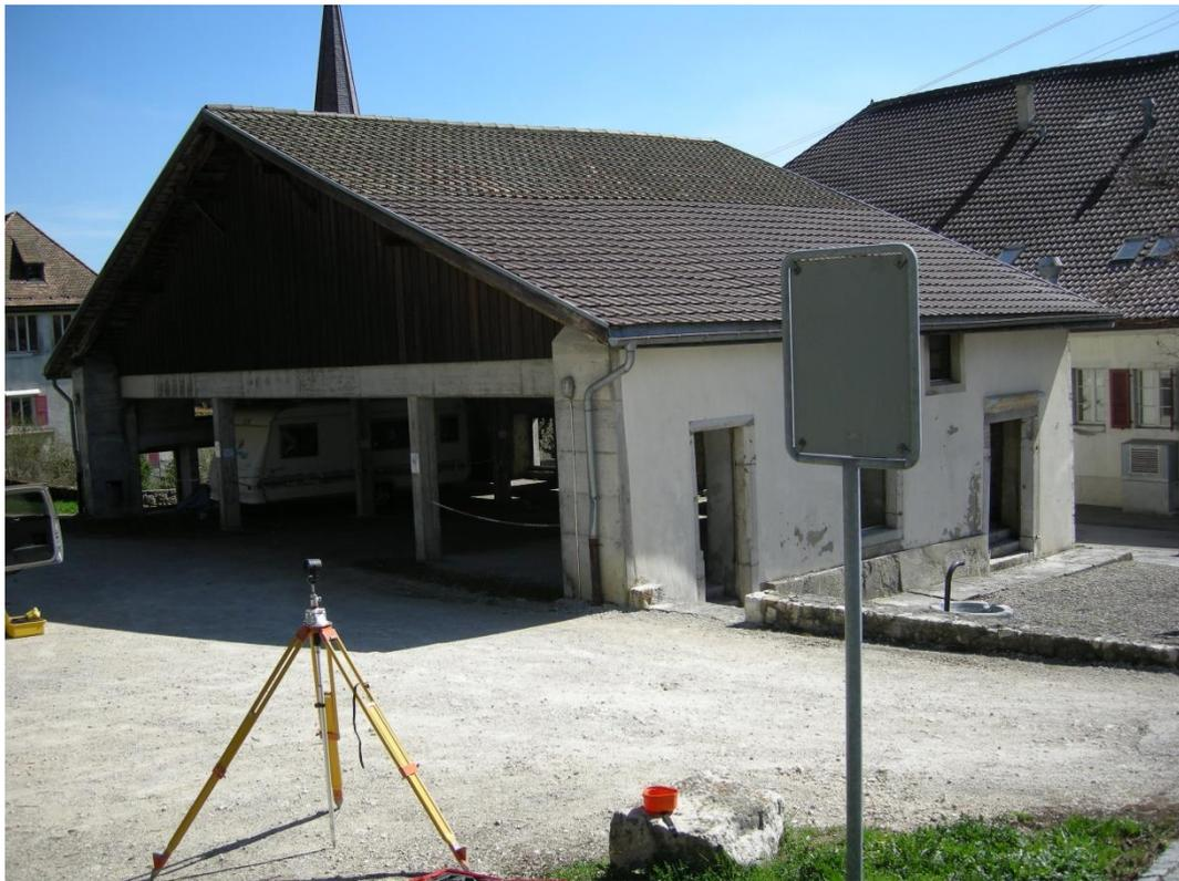
Abbildung 22: Beispiel einer Kontrollfläche (eingemessen wurden die geneigten Dachebenen in Lage und Höhe)
