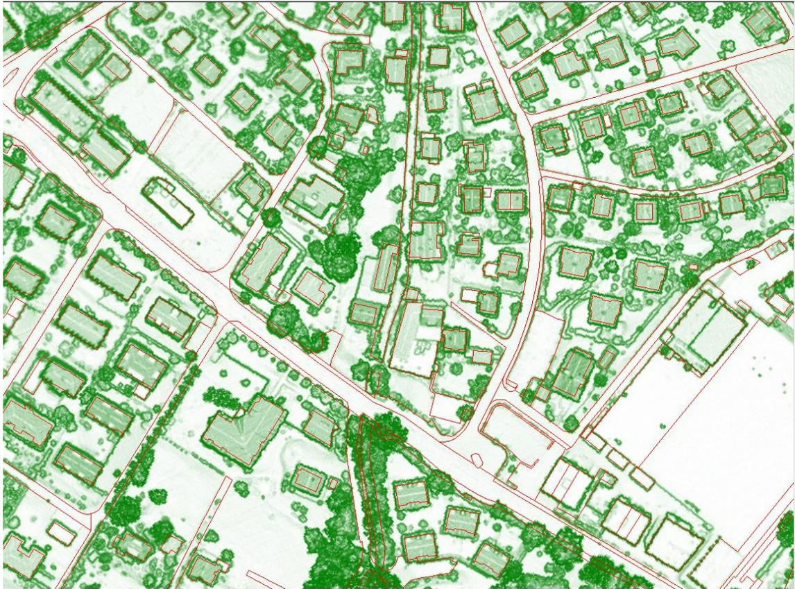
Abbildung 63: Lagekontrolle mit Daten amtliche Vermessung Region Thun/Gunten
