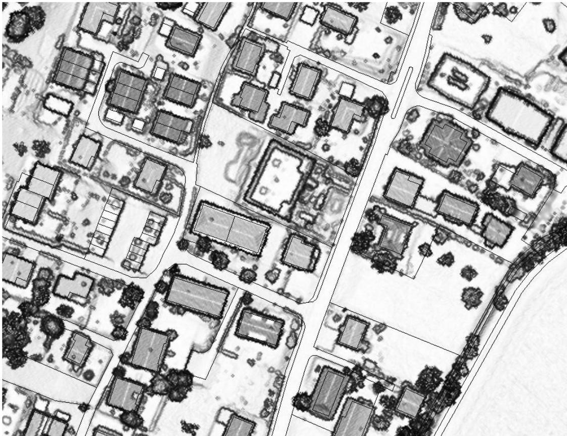
Abbildung 86: Beispiel Lagekontrolle mit Daten amtliche Vermessung
