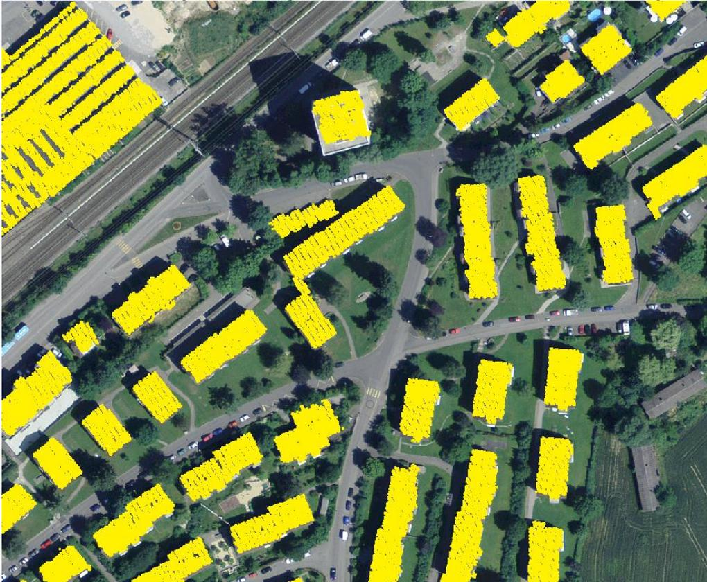
Abbildung 25: Beispieldarstellung für die visuelle Überprüfung der Klassifikation (dargestellt ist die Klasse 6-Gebäude)
